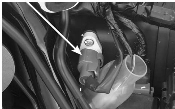
MANGUEIRA DE VÁCUO SENSOR MAP PARAFUSO CONECTOR 2P (Cinza) CONECTOR 3P (Preto)
